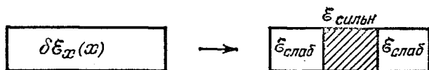
Рис. 16.13. Флуктуации электронной температуры и напряженности поля в образце с характеристикой N -типа приводят к образованию электрического домена. Справа на рисунке заштрихован домен сильного поля.
