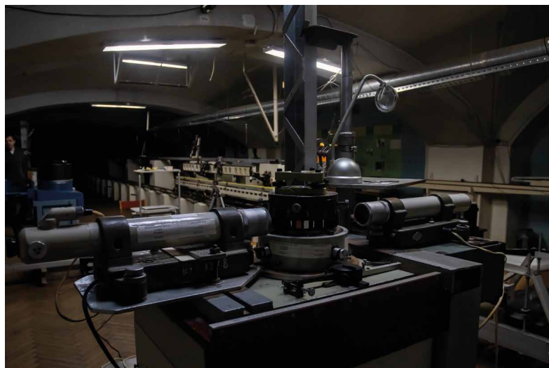
Угловой стенд с эталонной 24-гранной призмой и автоколлиматорами, предназначенный для поверки теодолитов и тахеометров
