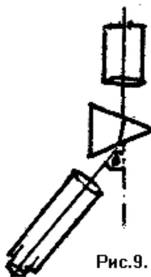
2. Наведите зрительную трубу на нужную вам линию (например, желтую). Не меняя положение трубы, слегка вращайте столик с призмой так, чтобы угол отклонения вашей линии уменьшался. При вращении призмы в этом направлении линия вскоре остановится и повернет назад. В момент остановки линии положение призмы соответствует установке на угол наименьшего отклонения для данного луча.
